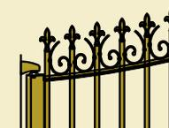
Ajouter 70 mm au dépassement des pics en cas de mise en place de volutes simples en partie haute (entre les embouts décoratifs).
