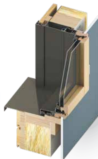
Adaptation pour mur ossature bois (HEMOB)
